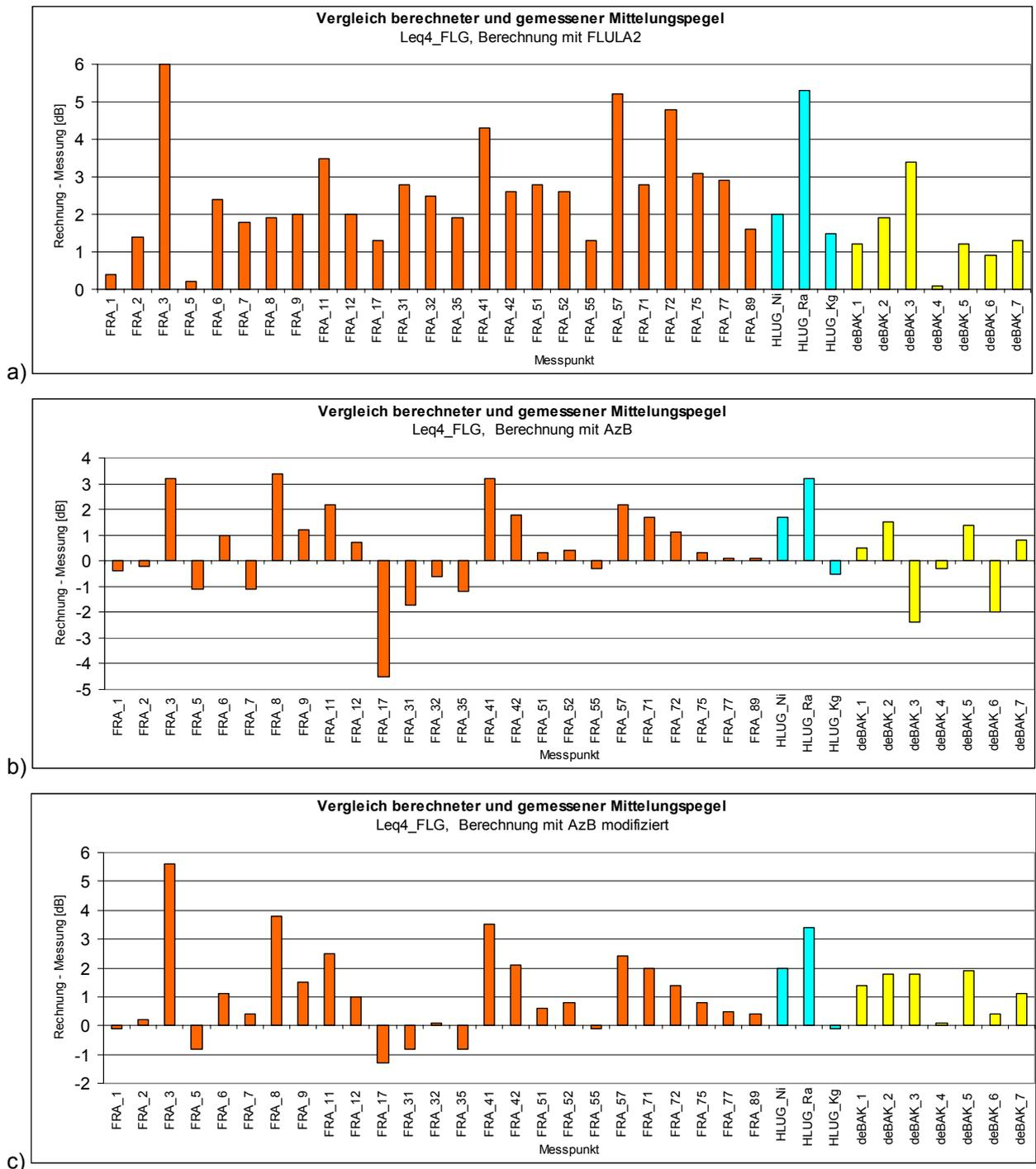
**Abbildung 6-1** *Differenzen zwischen den mit verschiedenen Berechnungsverfahren berechneten und den gemessenen Mittelungspegeln Leq(4)\_FLG an verschiedenen Messstationen. Berechnung mit FLULA2 (a), Berechnung nach AzB/99 (b), Berechnung mit modifizierter AzB (c).*
